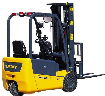
3-riteņu elektroiekrāvējs (akumulators uzlādējas no iekrāvēja bremzēšanas), bez slēgtas kabīnes, piemērots darbam telpās
