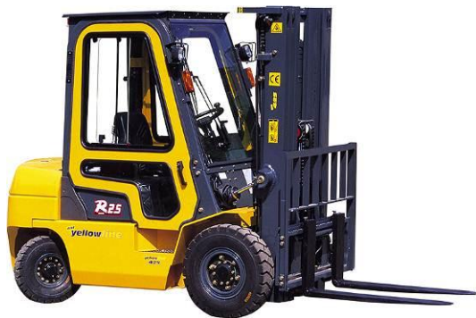
Autoiekrāvējs ar slēgtu kabīni, kas aizsargā nodarbināto pret nelabvēlīgiem laika apstākļiem
