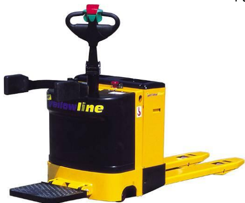
Elektriskie palešu ratiņi ar atlokāmu platformu operatoram
