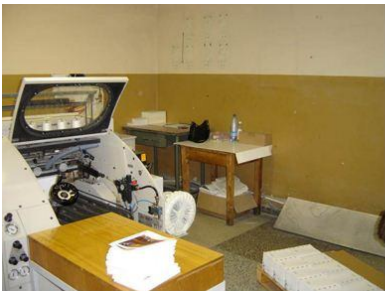
1.attēls. Darbs pie darba aprīkojuma, kam darba laikā nav aizvērti aizsargi.
